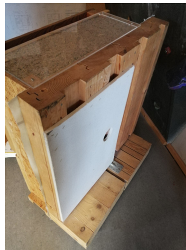
Schnitt Massivholzwand Putzträger M 1 : 10
